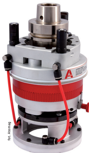
Agregat Soft Touch Pro oferuje dużą elastyczność w zakresie różnych możliwości zastosowania. Jest to możliwe dzięki wymiennym czujnikom pomiarowym i adapterom narzędziowym, co pozwala na stosowanie różnych narzędzi o różnej długości bez konieczności ponownej kalibracji narzędzia.
