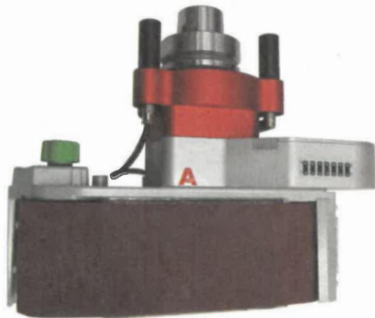
Das Atemag-CNC-Bandschleifaggregat stellt eine Lösung dar, um die Funktionen eines Bandschleifers in eine CNC-Maschine zu integrieren. Damit ermöglicht es präzise Schleifbearbeitungen von konvexen und unebenen Holzkanten in CNC-Holzbearbeitungsmaschinen. Das Aggregat wird über den Werkzeugwechsler aufgenommen und in die Spindel der
