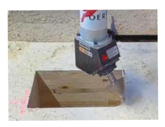
/ Ermöglicht das Ausspitzen von Ecken auf kleinstem Raum von 200 x 200 mm.
